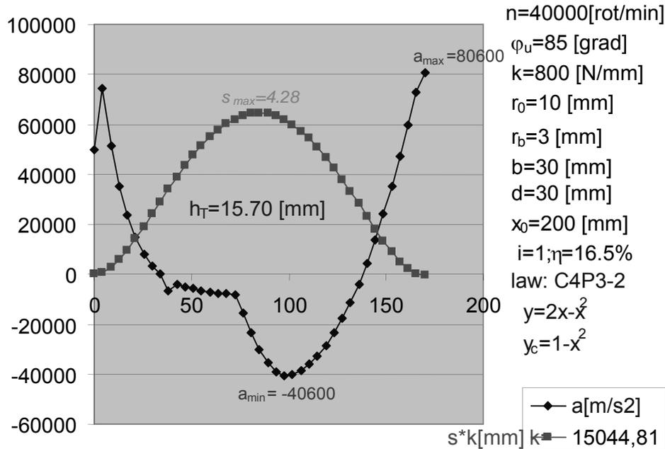
Figure 6. Law C4P3-2, Module F,  $\varphi_u=85^0$ ,  $n=40000$  rpm
